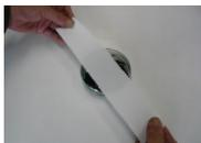
※1分間摩擦した加工布を粉状カーボンに近付け付着量を比較
